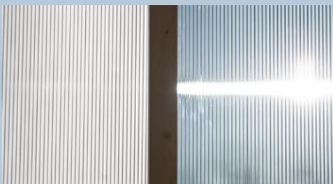
Unsere Stegplatten erhalten Sie sowohl in klarer (links) als auch in opal weißer (rechts) Ausführung. Der Unterschied bei den opalen Platten besteht darin, dass diese Pigmente enthalten, die den Lichteinfall verändern. Dadurch wird ein Blenden durch Sonneneinstrahlung stark reduziert (siehe rechts im Bild). Die Lichtdurchlässigkeit verändert sich dadurch nur geringfügig. Weiterhin sind Verschmutzungen durch Laub und Staub bei den Stegplatten in opal weiß nicht so stark zu erkennen.
